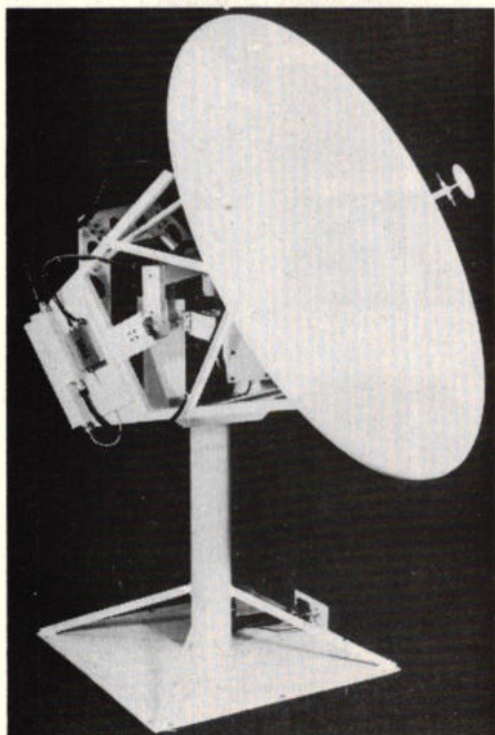
Afb. 2. Scheepsantenne met verwijderde fiberglas-beschermingskoepel.
